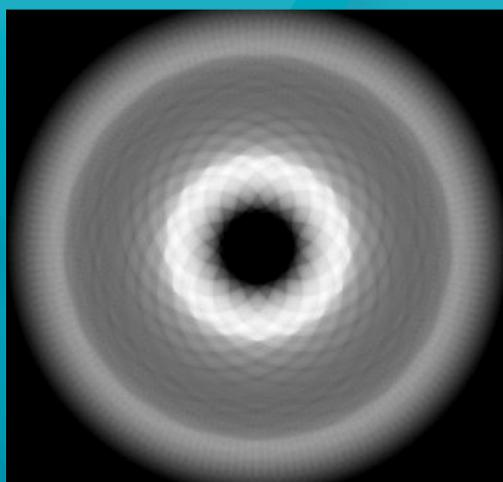
Die Grafik zeigt eine schematische Darstellung des Verschleißes einer herkömmlichen Schleifscheibe. Die hellen Flächen zeigen einen höheren Verschleiß.
